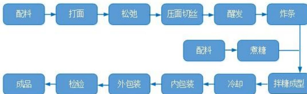
B、肉松饼生产工艺流程图：使用和面机、包馅机、酥饼成型机、热风旋转炉、枕式包装机、金属检测仪等设备。肉松饼主要生产原料包括面粉、绿豆、色拉油、肉松、单甘酯、水、白糖、山梨糖醇液、食盐、味精、脱氢乙酸钠、山梨酸钾、柠檬酸。
