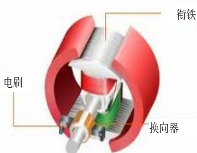
交流换向器电机切面图
