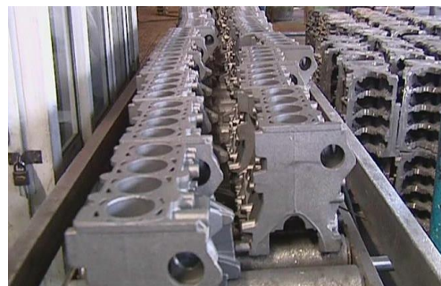
清理后的缸体铸件
