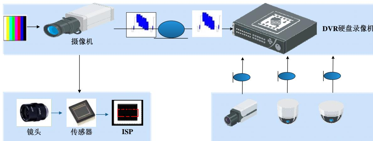
ISP 芯片集成了包括 CFA 插值、白平衡校正、伽玛校正、3D 降噪、边缘增强、伪彩色抑制、宽动态处理等功能模块，并集成可用于用户编程的微控制器，在获得高性能的同时，还大幅优化了芯片功耗和物理面积，使得视频监控摄像机具有了清晰度高、低光性能好、体积小、功耗低等显著特点。
