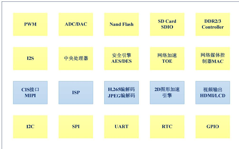
其中，CIS 接口完成对 CMOS 图像传感器数据的接收；ISP 完成对图像数据信号的处理；H.265/JPEG 编解码模块完成视频、图像编解码工作；2D 图形加速引擎完成图像显示的前处理；视频输出模块完成对 LCD 屏/外接显示器的驱动。其它模块为芯片外设接口模块，如 DDR 接口、Flash 接口等。
