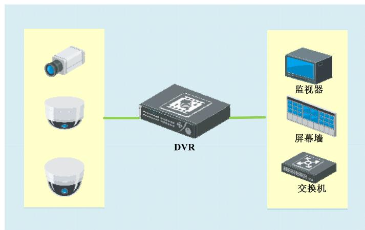
DVR SoC 芯片集合了录像机、画面分割器、云台镜头控制、报警控制和网络传输等功能于一身，可被看作是一套可进行图像信号处理、压缩、存储、传输功能的计算机系统。
