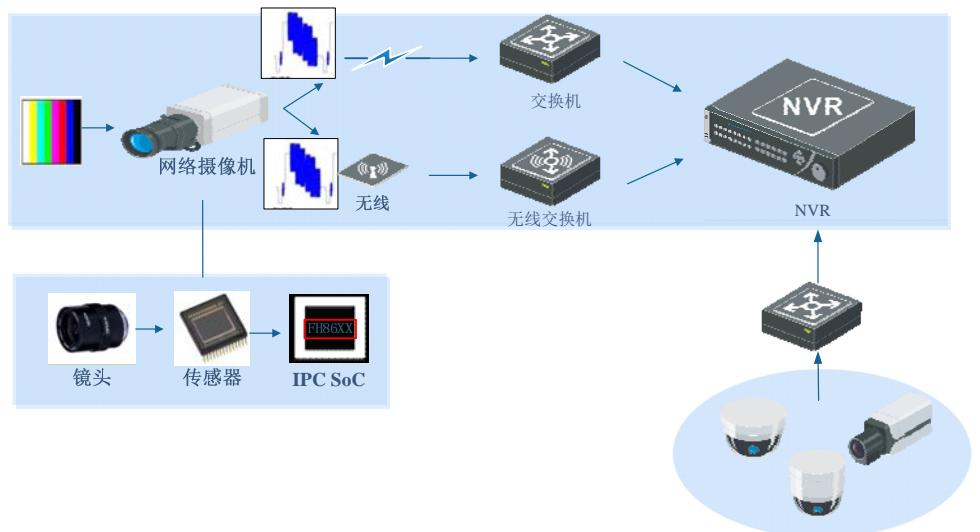
IPC SoC 通常集成了嵌入式处理器（CPU）、图像信号处理（ISP）模块、视音频编码模块、网络接口模块、安全加密模块和内存子系统，部分芯片还集成了视频智能处理模块。其中 ISP 处在处理流程的最前端，ISP 性能直接影响编码后的图像质量和压缩效率。
