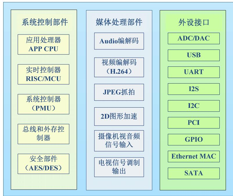
DVR SoC 芯片集成了中央处理器（CPU）、图形处理器、视频编解码器、显示控制器、总线控制器、内存子系统、音频处理器等功能模块，在获得高性能的同时，还特别加强了多媒体处理能力，具有接口丰富、功耗低、可靠性高等显著特点。
