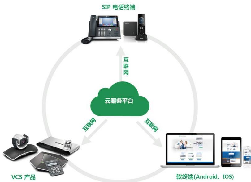
如上图所示，公司拟构建的统一通信解决方案包含终端解决方案和云服务平台解决方案，其中硬件终端（包括 SIP 电话终端和 VCS 产品）主要用来满足统一通信的基础需求；软件终端旨在解决移动办公通信需求的专业化和高效化问题；云服务平台旨在解决多设备通信不断提升的繁复性和多元化问题。公司的统一通信终端解决方案由公司现有 SIP 产品、DECT 产品、VCS 产品及正在开发中的软件终端及云服务平台组成。公司的 SIP 桌面电话终端包括高性价比的 T2、T3 系列，以及向对技术规格及先进性要求较高的用户提供的 T4、T6、VP 系列。公司的 DECT 电话终端使用户能够在办公室或家庭享有无线环境，使通讯更为便捷，VCS 产品能够满足办公环境下高效视频会议协作及通信需求。公司正在开发可用于跨设备（如平板电脑及智能手机）的软件终端，该软件终端可通过云服务平台整合所有其他设备，共同建立基于云服务的统一通信生态系统。
