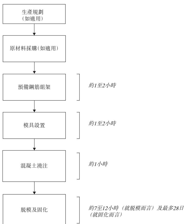
程序由混凝土澆注至脫膜歷時約八小時，因為生產過程中所使用的鋼筋組架及模具在該程序前已準備好。混凝土產品一經形成，初步固化程序隨即開始。進行脫模前，有關產品留在模內固化約七小時。一經脫模，混凝土產品將固化最多七至28日。
