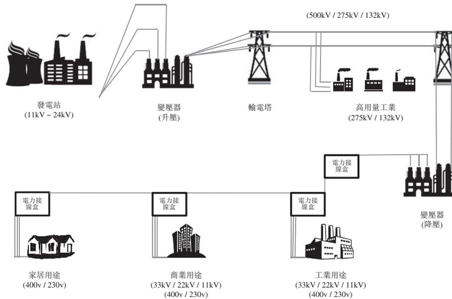
為將電力由變電站輸送至其用戶，電力接線盒（如我們的預製混凝土電力接線盒）用以接合及引導鋪設在地下的電纜網絡，該網絡能同步配電至各點。變電站的電力分多個階段分配予用戶。各階段需要不同大小的電力接線盒，以(i)接合及引導地下電纜網絡至不同的點；(ii)保護電纜；及(iii)在電力中斷時增加可追溯性。
