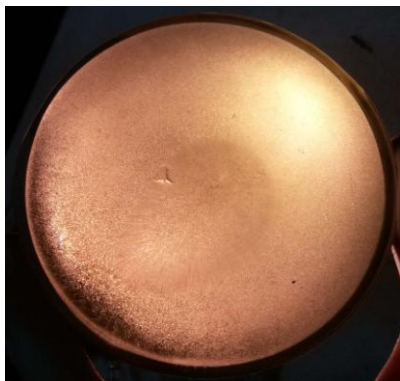
图 3、X 英寸半绝缘型碳化硅晶体
