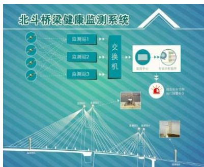
桥梁健康监测系统
