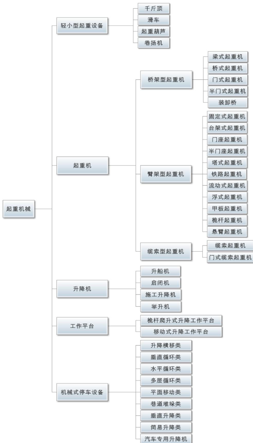
公司主要产品欧式起重机属于桥架型起重机中的桥、门式起重机范畴。公司其他起重机产品中旋臂吊属于臂架型起重机，电动葫芦属于轻小型起重设备范
