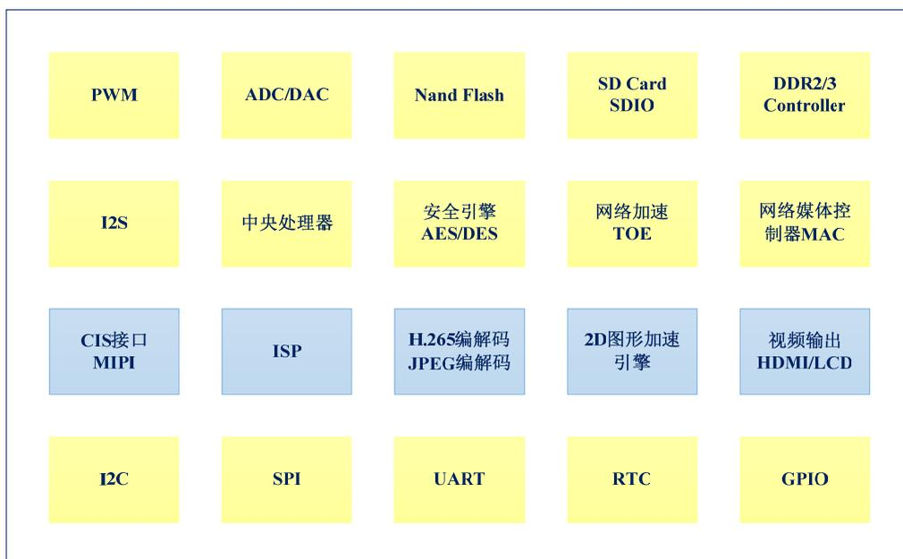
其中，CIS 接口完成对 CMOS 图像传感器数据的接收；ISP 完成对图像数据信号的处理；H.265/JPEG 编解码模块完成视频、图像编解码工作；2D 图形加速引擎完成图像显示的前处理；视频输出模块完成对 LCD 屏/外接显示器的驱动。其它模块为芯片外设接口模块，如 DDR 接口、Flash 接口等。
