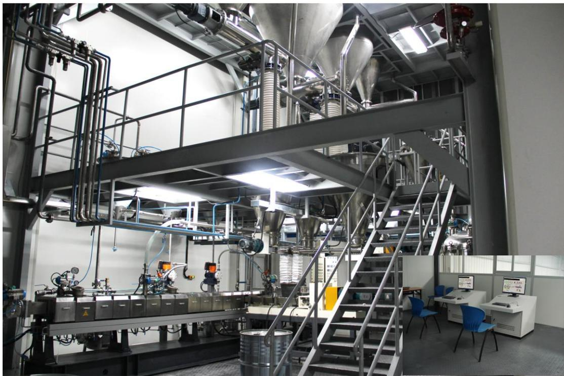
锂电池浆料全自动双螺杆生产线局部图
