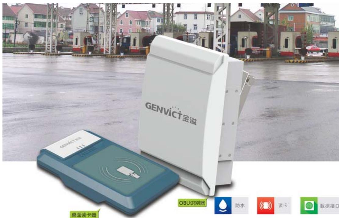
集成电路卡 (IC) 读写器是公司专门为智能交通系统用户量身定做，适用于采用集成电路卡 (IC) 收费系统的应用场合，是面向高速公路人工收费车道 (MTC) 的应用，由室内单元和室外单元组成。其中室外单元安装于人工收费 (MTC) 车道的前端，用于提示收费员，进入 MTC 车道的车辆是否安装了 OBU 电子标签，并读取 OBU 上存储的路径信息；室内单元安装于人工收费车道 (MTC) 收费亭内，用于读取双频复合卡和高速公路通行卡上的信息。
