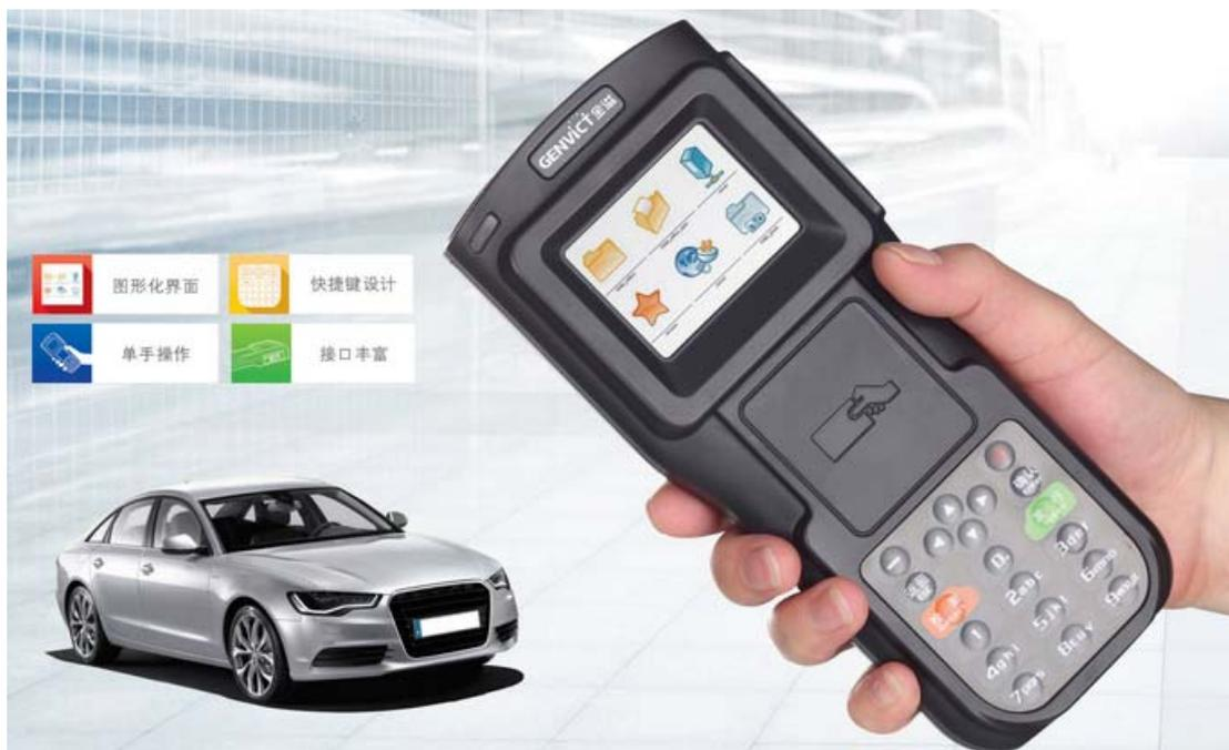
发行设备产品是公司专门针对 ETC 营业网点、银行、汽车 4S 店、加油站等电子标签发行网点,研发的一款有线/无线通信技术的支持联机或脱机发行的手持发行器。该产品联机/脱机密钥认证方式及配置了高清摄像头,支持联机/脱机校验、远程管理,数据安全性更强,应用适应性更广, OBU 安装发行更为便利。能够有效降低后期培训及运维成本。同时可根据行业需求进行个性化定制,具有良好的可扩展性。
