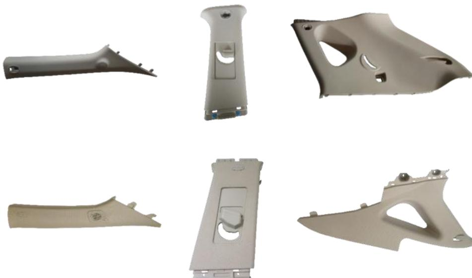
立柱护板总成为覆盖于车身侧围立柱的装饰物，用于美化整车内部造型及保护驾乘人员。汽车内饰的立柱护板系统由前至后一般包括 A 柱上下护板、B 柱
