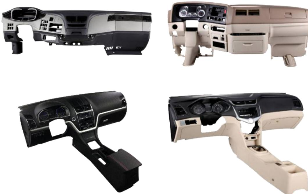
仪表板总成是汽车全车操控和显示的集中部分，是汽车上重要的功能件，位于驾驶员正前方，集成了仪表、电器、空调、娱乐系统和安全气囊等部件，除主仪表板和副仪表板本体外，还配有仪表罩、出风口、除霜风口、风道、安全气囊托架及盖板、手套箱、烟灰缸、装饰条、扶手箱等，是汽车内部较为复杂的内饰件总成。
