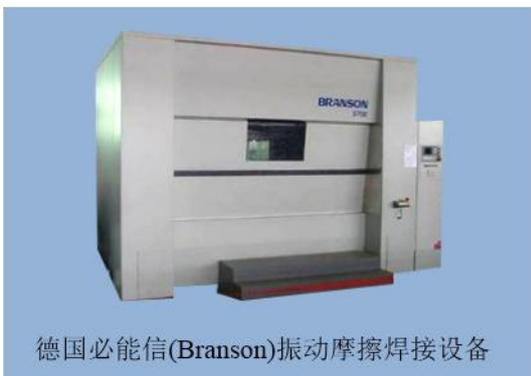
德国必能信(Branson)振动摩擦焊接设备
