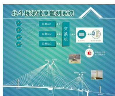
桥梁健康监测系统
