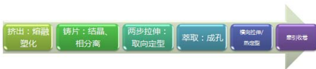
图一 湿法隔膜生产主要工艺流程
