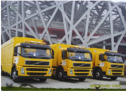
➤ 中航动科 QD16B 型号车载燃气轮机发电机组配套消声过滤装备（东安燃气轮机）。
