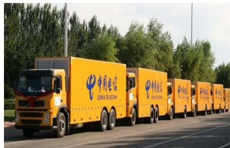
➤ 58/200/400kw 车载柴油机发电机组，应用于上海世博会应急备用电源。
