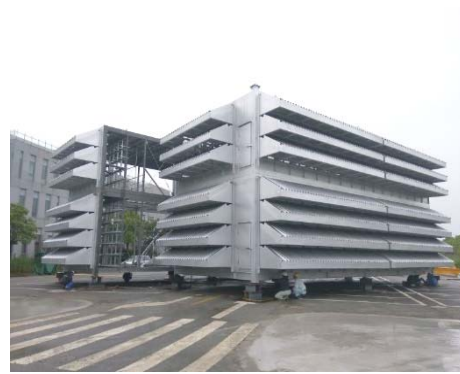
➤ 日本进和燃气轮机进气过滤室（GE 燃气轮机）。
