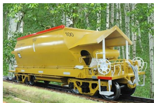
出口澳大利亚铁矿石漏斗车
