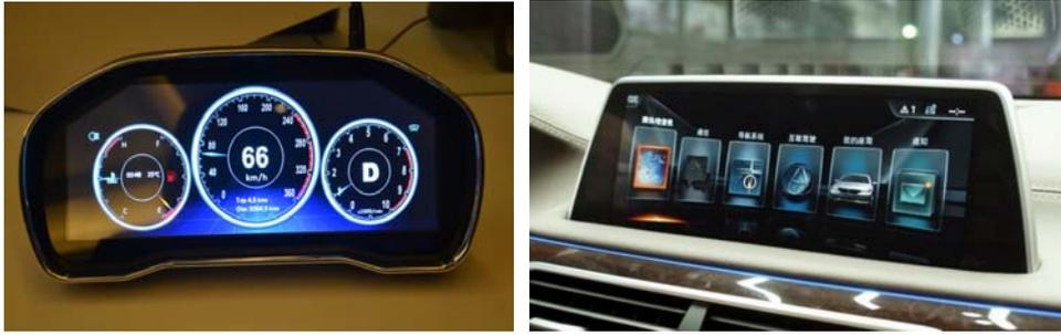
车载显示器需要适应更加复杂的运作环境情况，需通过高温、高湿、长时间的高标准测试，还需考虑防尘、耐震、防眩光、易识辨、亮度自动调节、电磁干扰等问题。车载显示器的高门槛成就了较高的毛利水平，一旦发行人进入该市场，将获得巨大的业绩增长空间。
