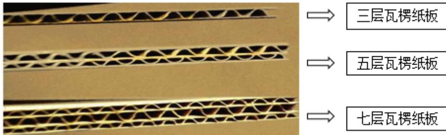
除了瓦楞纸板的层数之外，瓦楞芯纸的楞型不同也会影响瓦楞纸板的抗压性能及耐冲击强度。根据瓦楞高度及瓦楞形状的不同，目前常见的瓦楞楞型主要包括 A 型、B 型、C 型和 E 型等。不同瓦楞楞型的形状特点及具体应用如下：
