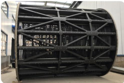
公司配套给中信重工 Φ7.9×13.6m 球磨机圆筒筛
