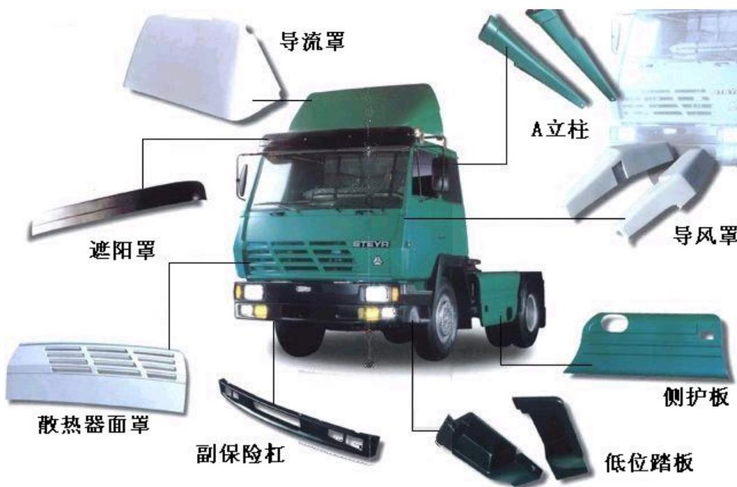
复合材料制品在工程车辆中的应用（二）
