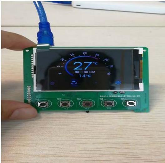
公司在无锡国家集成电路产业基地投资控股的无锡触联有限责任公司，上半年成功自主研发出了2.8寸中央空调液晶显示线控器，并将于下半年开始接受小批量订单。
