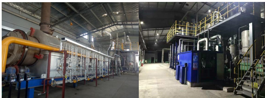
图 30 本技术研制开发的万吨级秸秆生物质热解炭化转窑生产系统（左）及产物分离提取利用系统（右）
