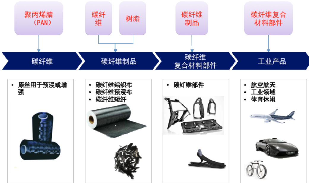
图6-5： 碳纤维产业链示意图
