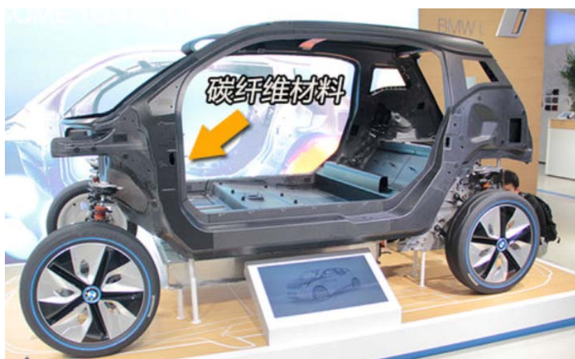
宝马 i3 碳纤维复合材料车体结构图
