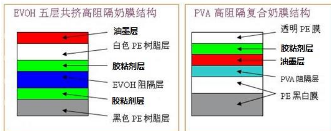
典型高阻隔表印型食品复合膜和里印型高阻隔食品复合膜剖面结构
