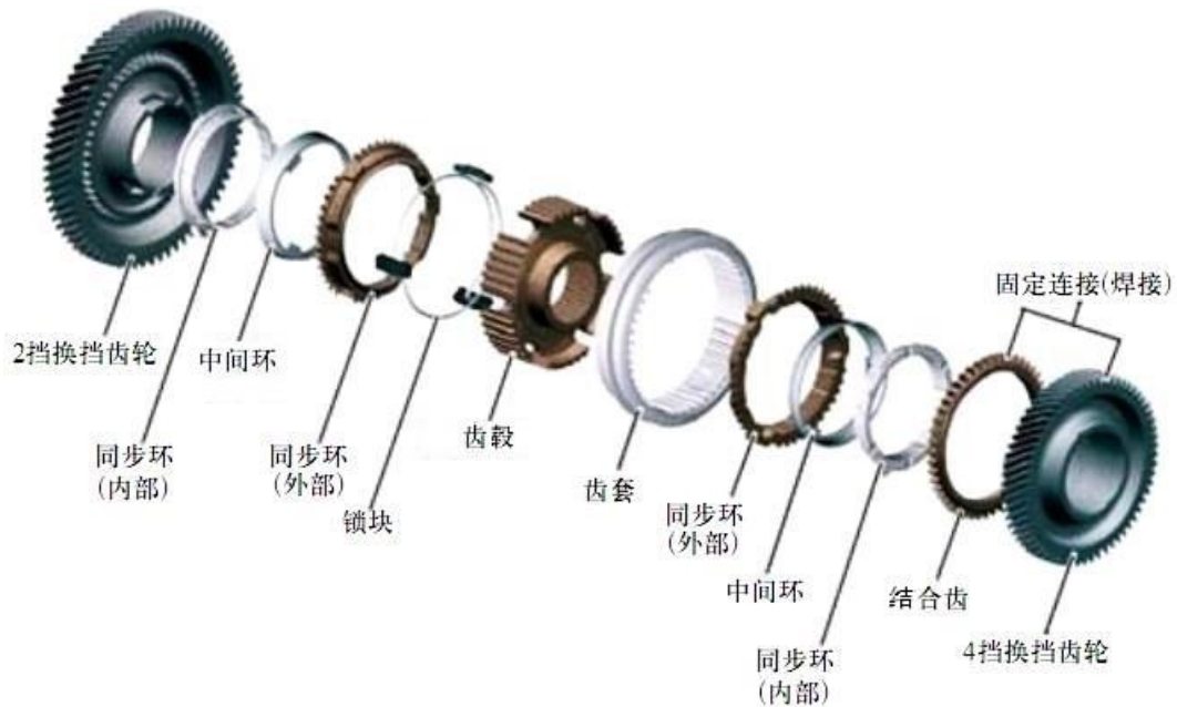
图：汽车变速器用同步器主要构成
