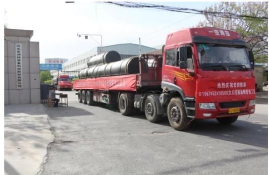
2017年5月5日，由我公司为浙江火电建设有限公司制造的直径1067mm，壁厚52mm，长度11.5米核级主蒸汽管道成功发货，是目前世界上口径大、长度最长的核级主蒸汽管道，说明了宏润核装的制管能力在国内处于领先水平。
