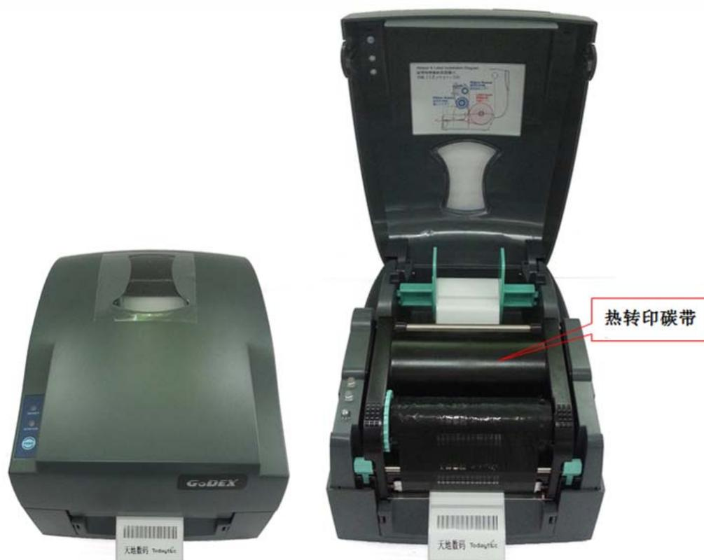
热转印技术最早使用在传真机和条码打印机上，就热转印技术在打印机的运用而言，1980年日本SATO公司推出了第一台热转印打印机，专门用于零售业UPC码的打印。热转印发展到现阶段技术已经趋于成熟，由于热转印打印机结构简单、使用成本低、使用寿命长、产品体积小等特点，再加上热转印打印机能满足工业领域在高负荷工作和灵活配置等要求，在专用打印机市场，特别是条码/标签打印机领域基本由热转印技术所占领。
