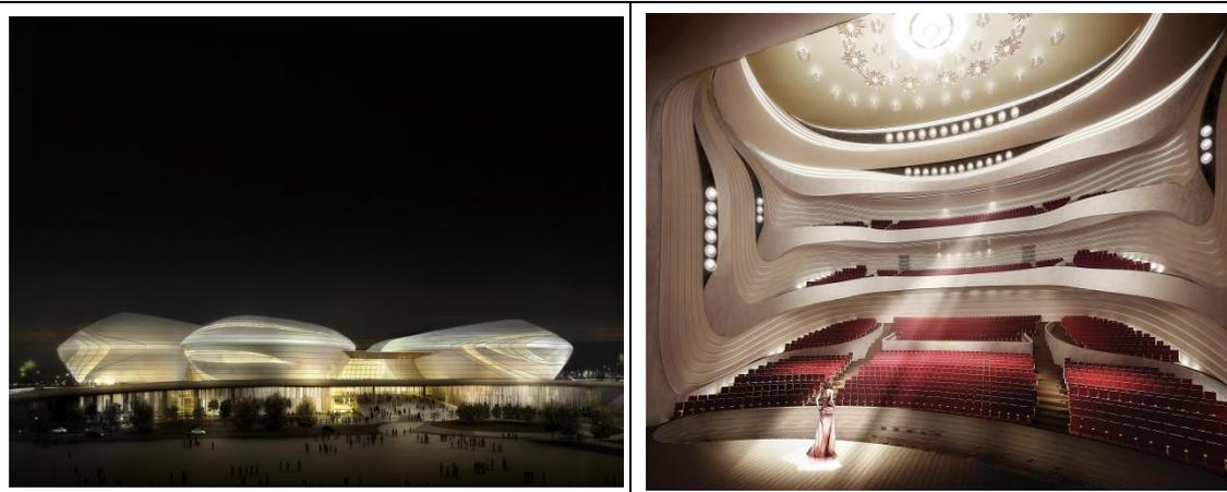
江苏大剧院歌剧厅水滴造型对声学装饰深化设计提出了难题，公司根据图纸打造模型，在做 CAD 的同时完善区域和房间 BIM 指导施工，反复进行声学评估、模型完善，保证项目最终实现从概念设计到施工图的落地。观众厅和前厅的 GRG 材料的应用，即满足设计和声学要求，同时更环保、可翻修，而对于前厅的弧墙，则大胆采用了不规则穿孔双曲铝板，大大降低了施工难度，实现了整体结构的统一性，方便后期的维护和保养。声光电工程集成上，秉承以自然声为主、电声为辅的理念，同时在追光位的布局上，将追光灯布置在观众厅最上
