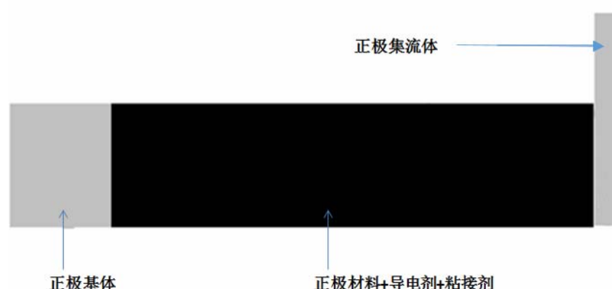
图：锂离子电池正极极片构成
