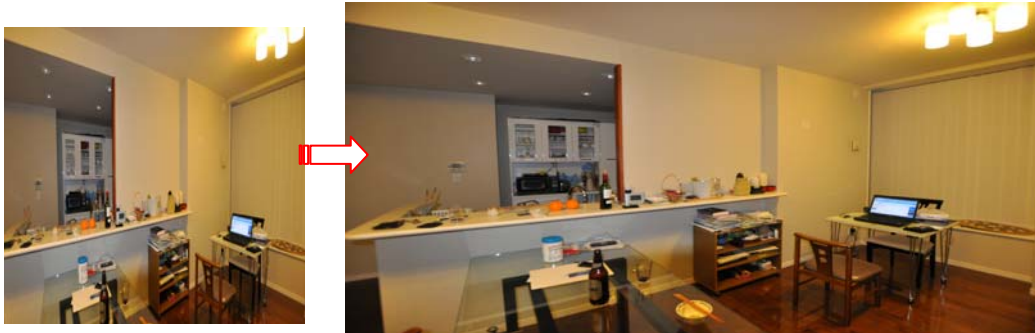
仙台某高层隔震住宅地震后室内物品无移动
