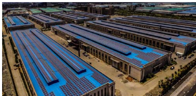
锦运再生 5,796.96 KWp 分布式光伏电站
