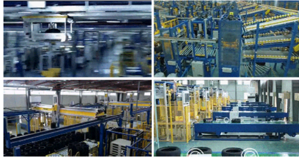
AGV（自动导引运输车）应用及自动化立体仓库示意图
