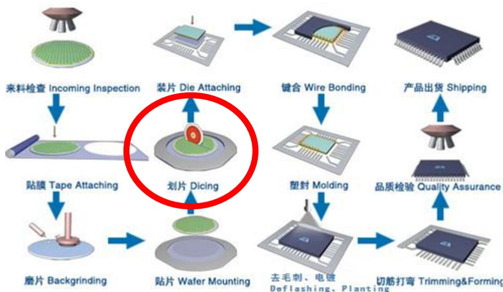
随着芯片的小型化、大容量化、以及高效化，芯片的结构越来越复杂，芯片之间的有效空间越来越小，因而其切割的空间也越来越窄。这对于精密切割晶圆的划片刀的技术要求越来越高。
