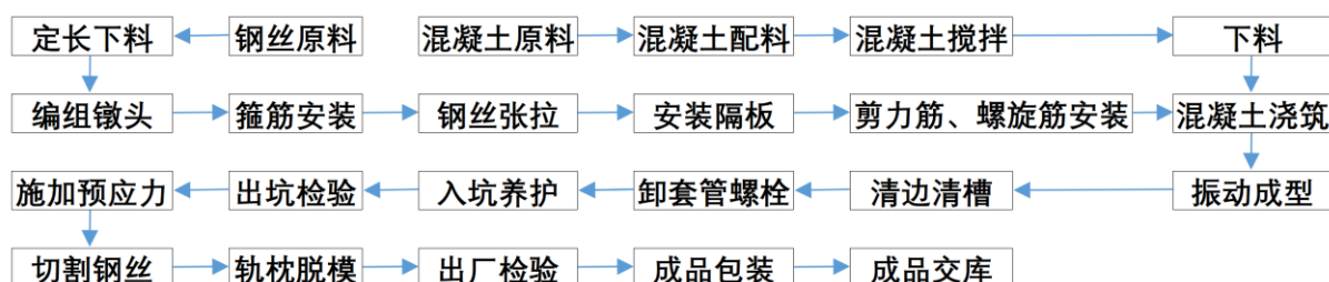
轨枕工艺流程图
