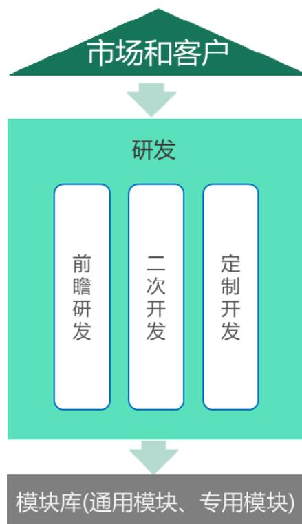
模块化的研发模式要求研发部门在开发新技术时，特别注重技术和部件的通用性，以适应于不同的机型。同时要求安装调试部门将设备在客户的实际使用情况不断反馈至研发部门，帮助技术的改良更新。
