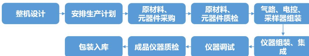
检测分析仪器工艺流程图
