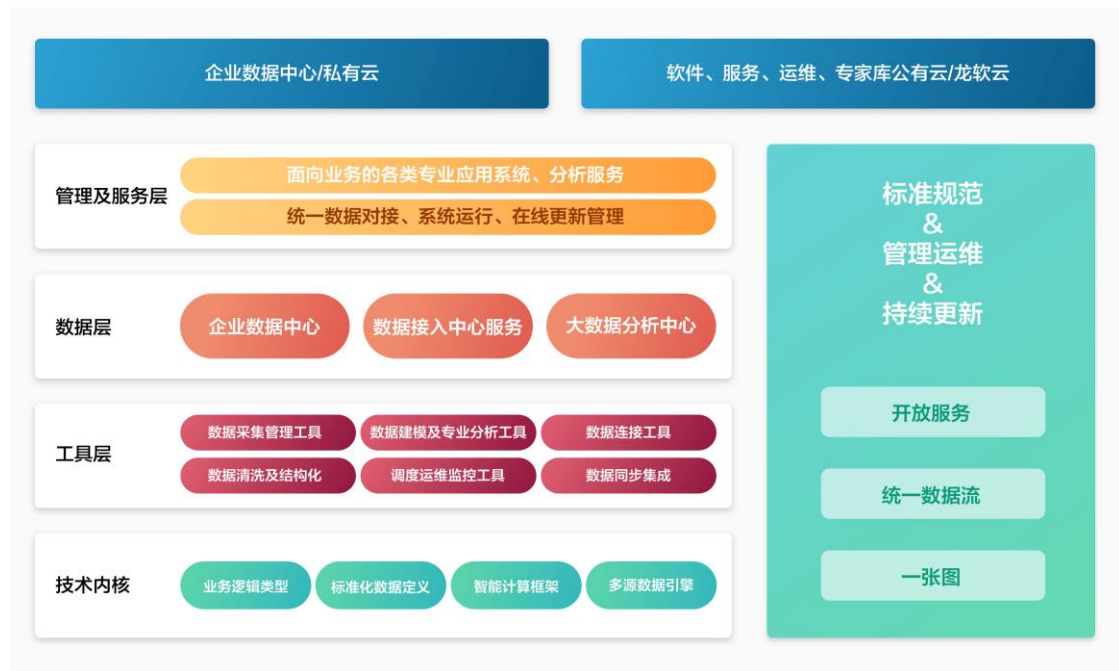
图 9-1 矿山安全生产大数据云服务平台技术架构图
