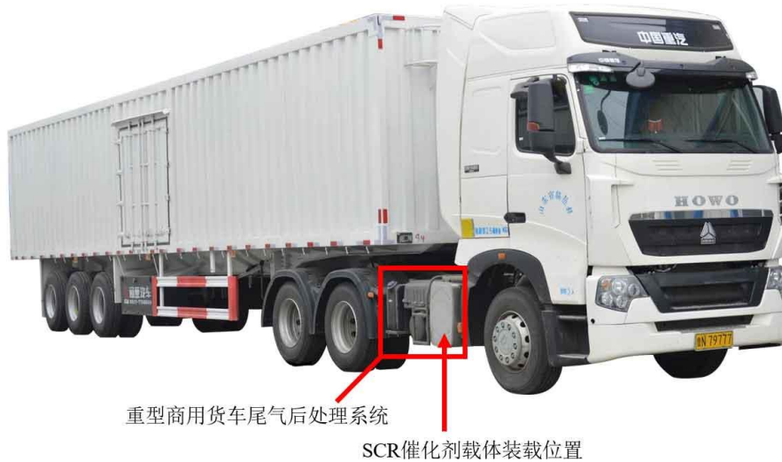
图：柴油重型商用车尾气后处理系统（国五）与 SCR 载体装载位置示意图
