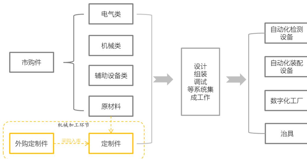
市购件主要包括：伺服系统、传感器、仪器仪表等标准化的机械、电气组件及钢材、橡胶、尼龙等原材料类
