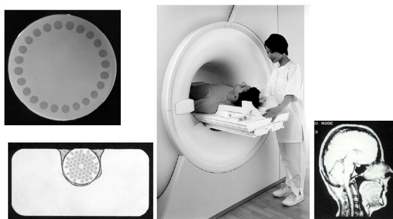
注：左图为 MRI 用超导材料，中图为 MRI 扫描仪，右图为头部成像
