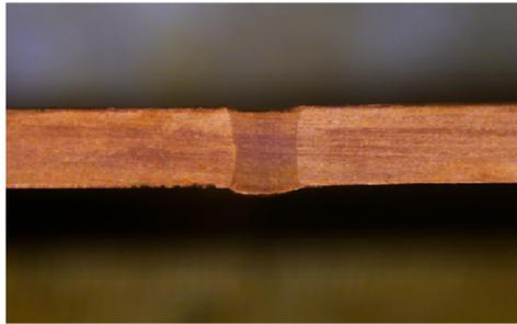
紫铜穿透焊内部结构图
