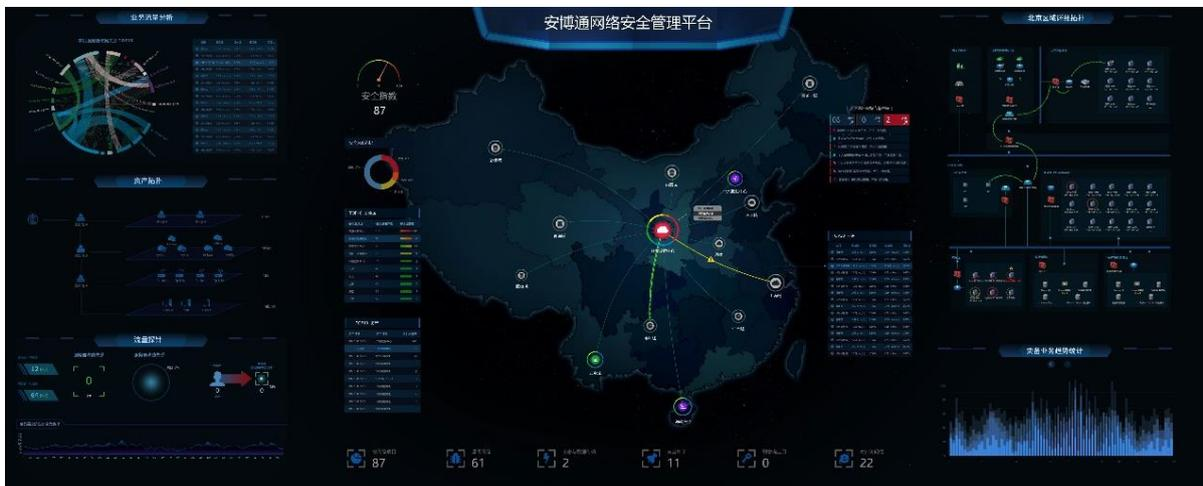
安全管理产品基于 ABT SPOS 网络安全系统平台开发，依据国家网信部门网络安全监测预警和信息通报制度的技术要求设计，部署在网络管理集中监控位置，通过大屏显示系统呈现和运维管理。该产品利用数据融合、数据挖掘、智能分析和可视化技术，直观显示网络环境的实时安全状况，对潜在的、恶意的网络攻击行为进行识别和预警，提升安全设备的整体效能，具备网络安全管理和预判能力，为网络安全提供运维保障，其工作流程如下图所示。
