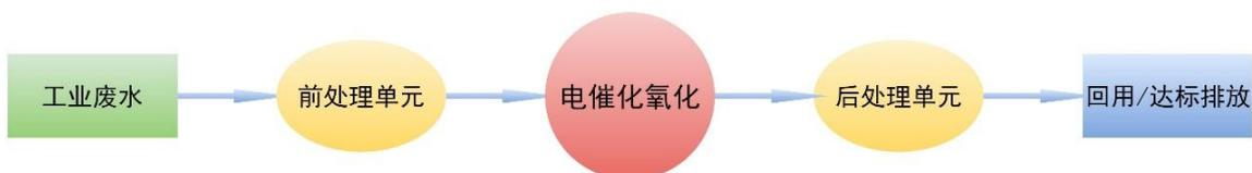
公司的高难废水电催化氧化处理系统及所使用的电催化氧化技术具有无需额外投加氧化剂、无二次污染、无污泥产生、矿化彻底、反应条件温和、绿色清洁、操作简单、自动化程度高等优势。电催化氧化技术所对应装置是工信部 2017 年《关于加快推进环保装备制造业发展的指导意见》中明确的水污染防治装备方面重点攻关的技术装备之一。公司的“折流式电催化氧化废水处理设备”经广东省环境保护产业协会鉴定，达到国内领先水平。公司该系统已成功应用于江门市崖门新财富环保电镀产业园废水处理厂的电镀废水处理。
