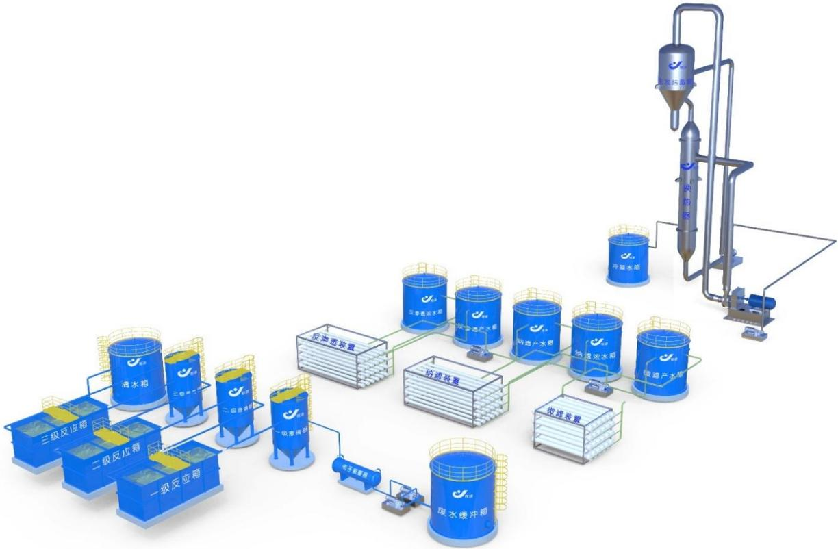
②高难废水高温离心雾化烟气蒸发零排放处理工艺
