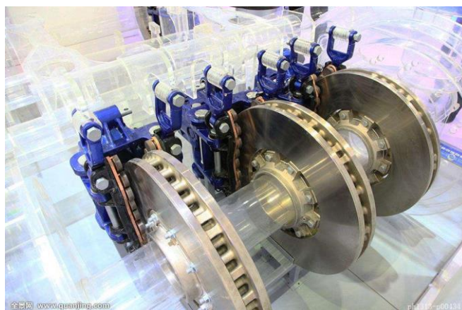
闸片与制动盘组成一对摩擦副（示意图）
