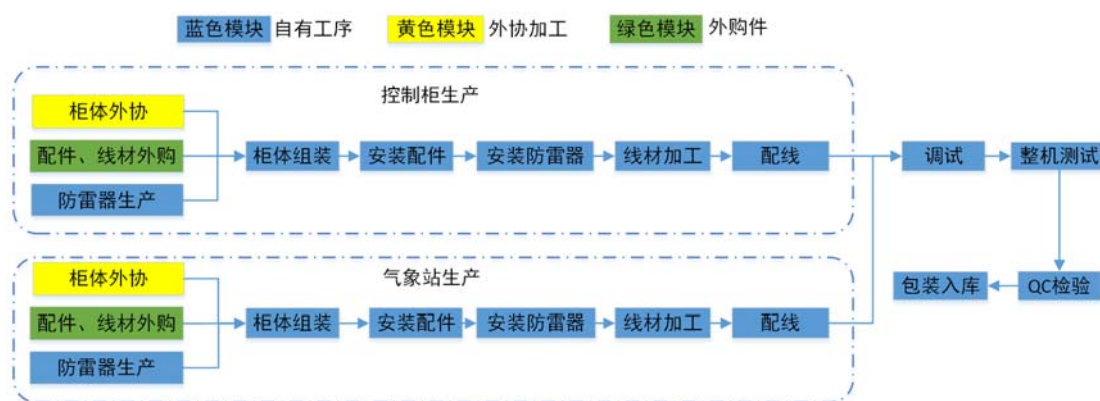
图6-26 道岔融雪系统生产流程
