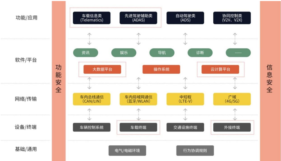
图：智能网联汽车产品物理结构
