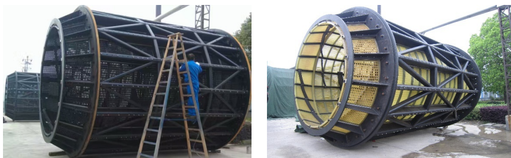
公司配套给中信重工 \Phi 7.9 \times 13.6\text{m} 球磨机圆筒筛
