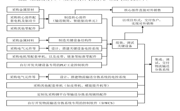
对于核心部件,公司根据客户设备性能的需求,从运行速度、稳定性、承载能力等方面定制化的为客户开发辊筒等核心部件产品,优化影响辊筒性能的结构参数、电气参数等,形成设计图纸。在生产阶段,公司实行"以销定产"的生产模式,制造部门制定详细的生产计划,进行生产调度、管理和控制,采购部门根据采购清单的要求进行选型、采购。完成生产后,公司对辊筒性能进行测试,确保满足客户需求。
