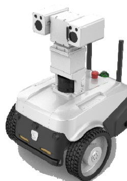
变电站轮式智能巡检机器人（三代）
