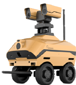
变电站轮式智能巡检机器人（二代）
