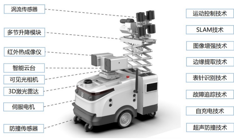
图：申昊科技配电站轮式智能巡检机器人
